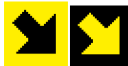
Abbildung 16: Zeichen für den Entscheidungspunkt einer Umleitung, Wiener Konvention Rv.2, 27. Mai 2010
